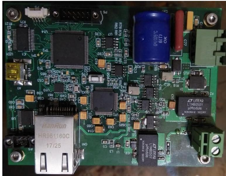
[۲] سیستم کنترل حلقه بسته موتورهای AC تا توان ۳ کیلووات؛ دانشگاه اصفهان
