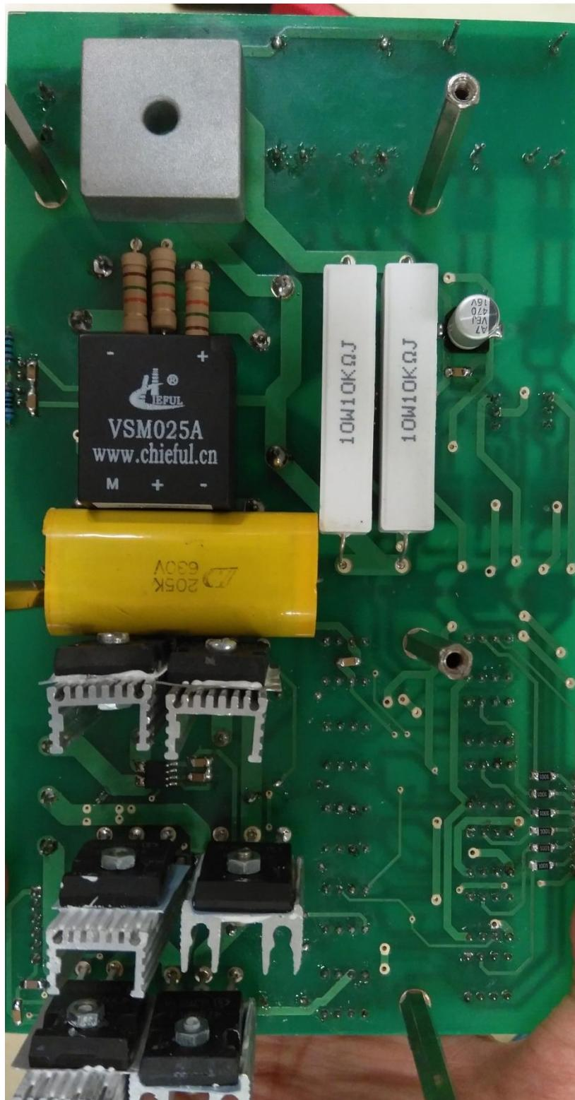
[۳] سیستم کنترل سرعت، گشتاور و جریان انواع موتورهای AC با توان ۱ کیلووات، دانشگاه اصفهان
