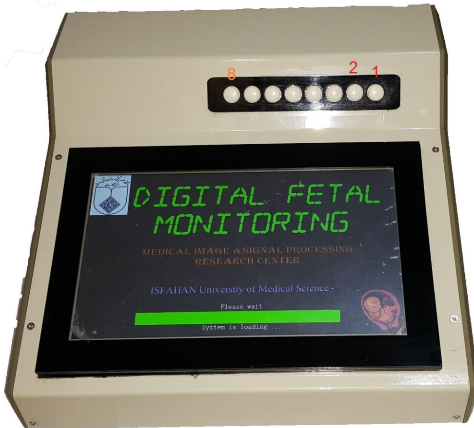
تصویر شماره ۳: نمونه فتال مانیتورینگ ساخته شده با نمایشگر ۱۰ اینچ
